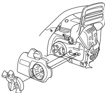
Установите пыльное полотно на специально предназначенные болты. Установите полотно в самое заднее положение. Оденьте цепь на ведущую звездочку и вставьте ее хвостовики в паз пыльного полотна. Начинайте с верхней стороны пыльного полотна.
