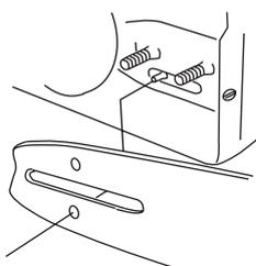
Натяните цепь, поворачивая колесо вниз (+). Цепь следует натягивать до тех пор, пока она не перестанет провисать снизу. См. указания в разделе Натяжение цепи пилы.
