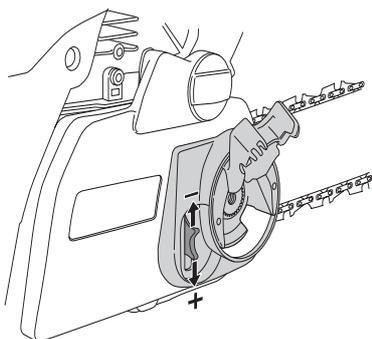
Цепь натянута правильно, если она не провисает под направляющей, но ее можно свободно повернуть вручную. Придерживая носовую часть направляющей, затяните ее сцепление, поворачивая ручку по часовой стрелке.
