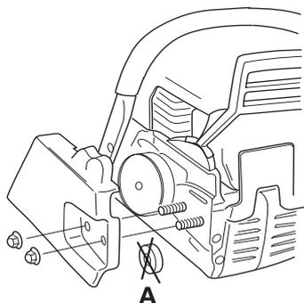
Установите пильное полотно на специально предназначенные болты. Установите полотно в самое заднее положение. Оденьте цепь на ведущую звездочку и вставьте ее хвостовики в паз пильного полотна. Начинать с верхней стороны пильного полотна.
