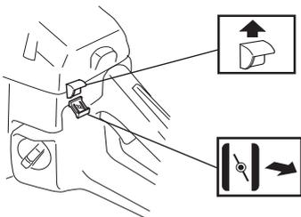
Если машина укомплектована топливным насосом (А): Сожмите несколько раз резиновую грушу топливного насоса пока в нее не начнет поступать топливо. Грушу нет необходимости заполнять полностью.
