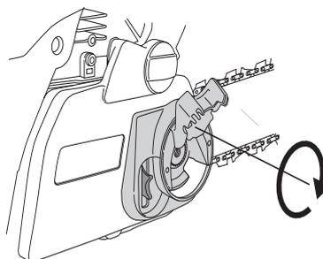
При установке новой цепи следует часто проверять ее натяжение, пока цепь не приработается. Регулярно проверяйте натяжение цепи. Регулярно проверяйте натяжение цепи. Правильно натянутая цепь обеспечивает высокое качество пиления и дольше служит.
