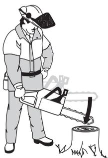
При прикосновении пыльного полотна к пню должен сработать тормоз.
